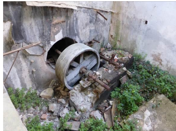
Volant que des de la turbina, per mitjà d'una corretja acciona l'alternador.
